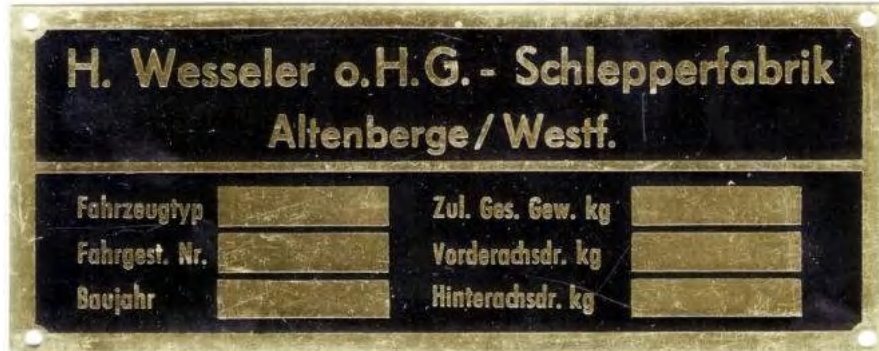
Wesseler-Typenschild, i.d.R. am Zwischenstück „Motor-Getriebe“ (Größe:150 x 60 mm)
