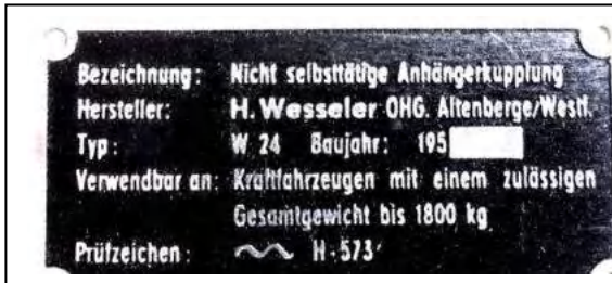
Typenschild „Wesseler-Anhänger-Kupplung“ W 24, bis 1800 kg (Größe 60 x 30 mm) (Kopie von TÜV-Bauartgenehmigung vorhanden)
