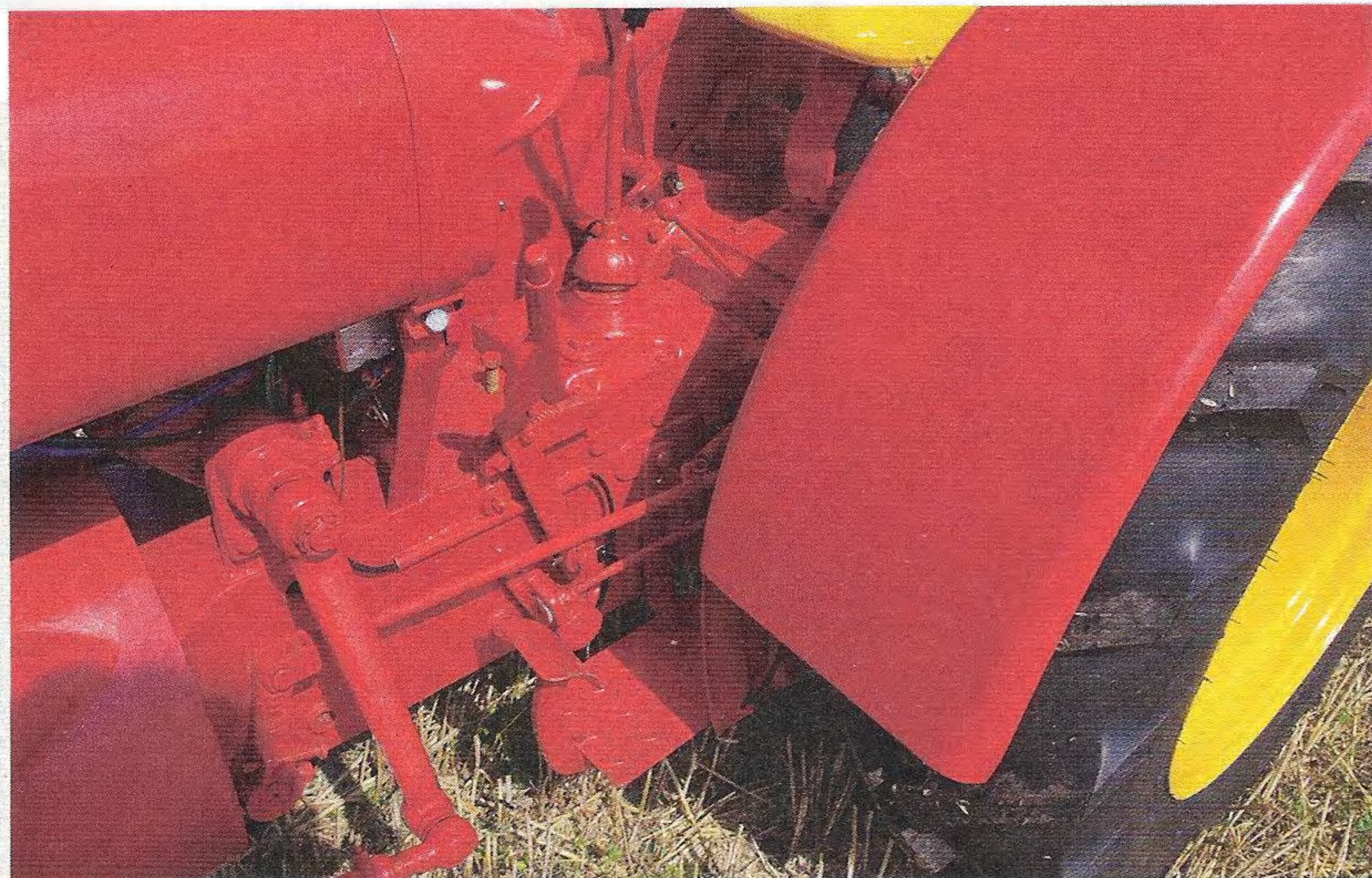
Die Trittbleche für den Aufstieg sind extrem schmal.
