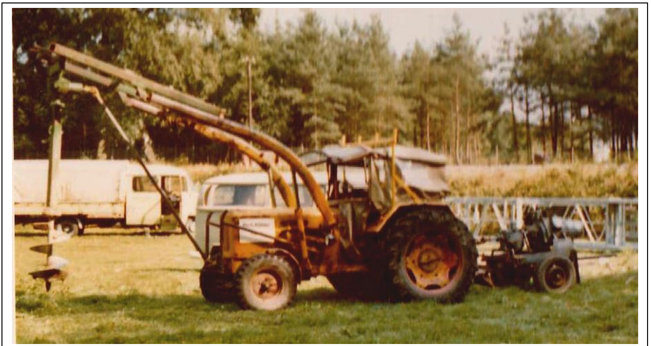
Wesseler-Schlepper mit Erdbohrer für Stromleitungs-Masten-Löcher
