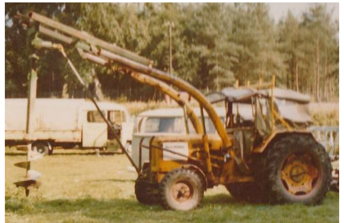
Wesseler-Schlepper mit Erdbohrer für Stromleitungs- Holzmasten. Antrieb über Zapfwelle/Antriebswelle, unter dem Getriebe- und Motorgehäuse nach vorne. WL 340 E, Baujahr 1963 und W 45, Baujahr 1964 im Einsatz beim Stromleitungsbau, Fa. Köhler, Laer
