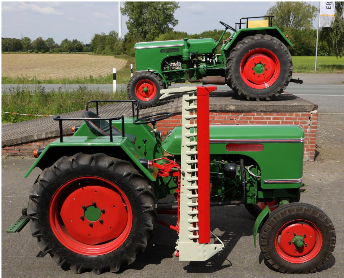
auf Rampe: Wesseler W 60, 56 Ps, Baujahr 1964 – wassergekühlt, unten: Wesseler WL 20, 20 Ps, Baujahr 1963 luftgekühlt, mit Raspe-Mähwerk bis ca. 1960, ab 1960 mit Mörtel Mähwerk
