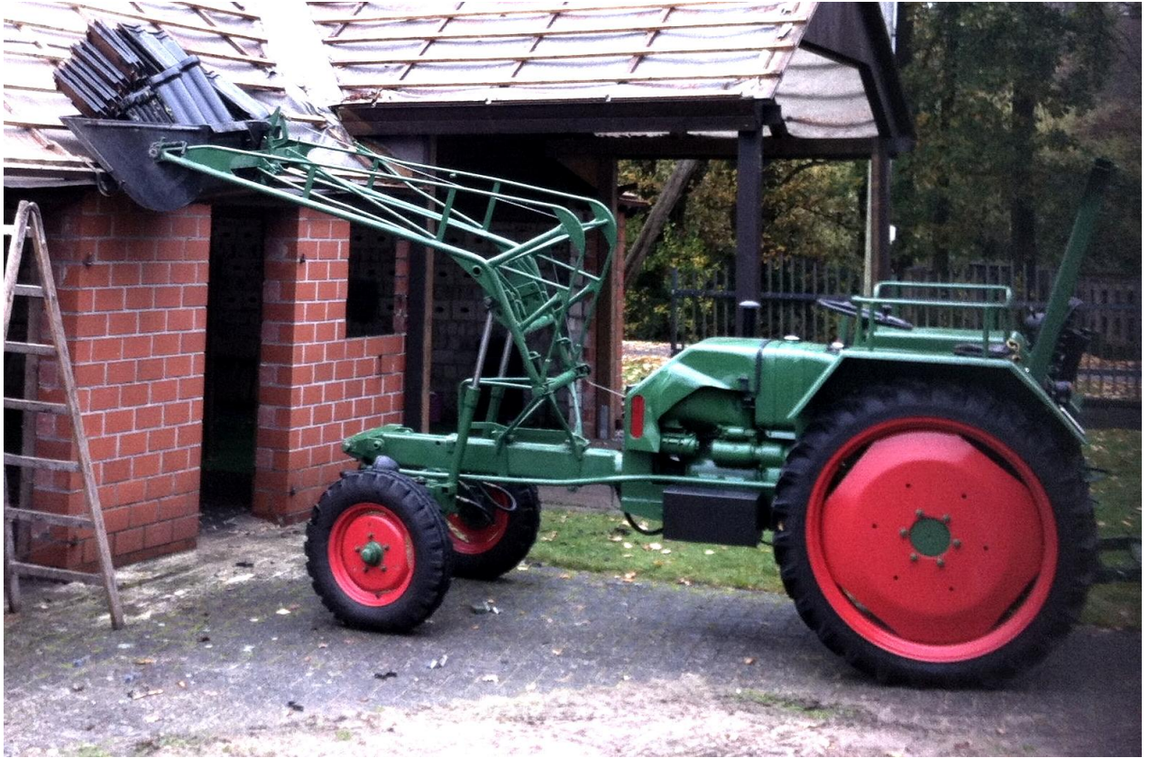
Wesseler Geräteträger WLK 225 mit Frontlader - Besitzer Andreas Landwehr, Langen 25 Ps – Baujahr 1963, Markenname Ackermeister
